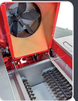
Die zentrale Saugvorrichtung lässt sich hydraulisch hochklappen, um Wartungsarbeiten leichter durchführen zu können.
