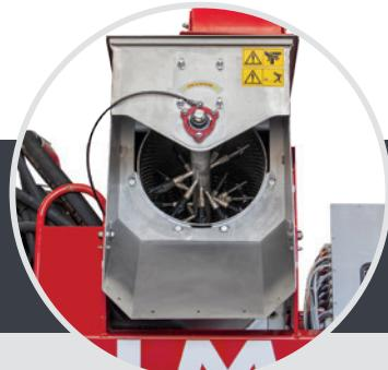
Die Geschwindigkeit des Sortierbodens, auf dem die Trauben getrennt werden, kann unterschiedlich eingestellt werden und besteht aus 16 Rollen mit gezahnten Scheiben, die die Trauben von den Traubengerüsten und Fremdkörpern trennen.
